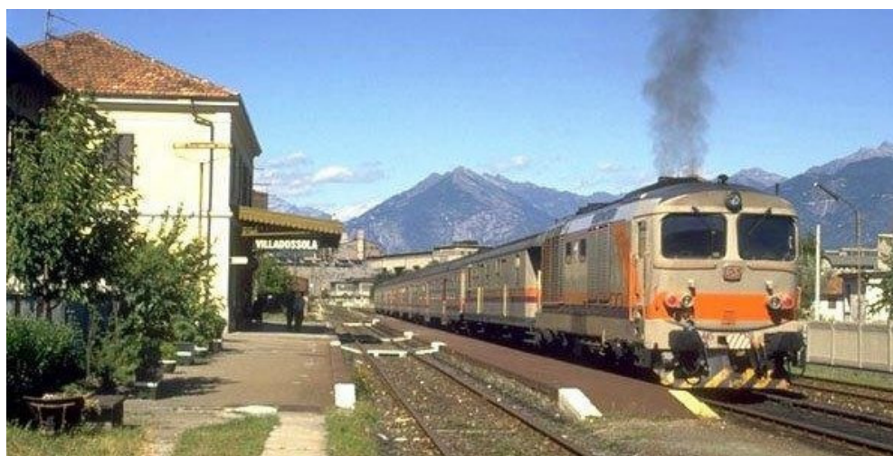
Figura 5.5-2: Locomotiva diesel-elettrica D.445
