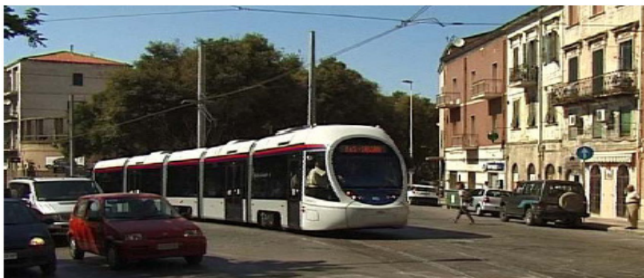
Figura 2.5.5: Metrotranvia di Sassari, tram Sirio (Ansaldo-Breda)
