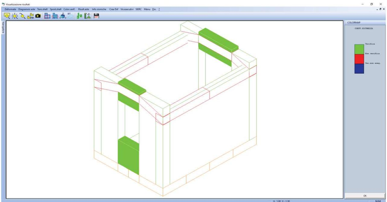
Figura 4 – Verifica travi di collegamento
