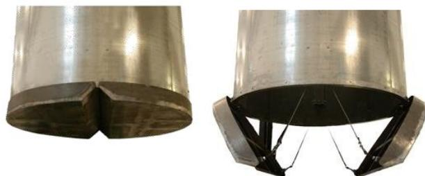
L'apertura angolare del fondo del cesto interno è prossima ai 90° per garantire un ottimale scarico a gravità dei rifiuti senza interventi da parte dell'operatore con la gru.
