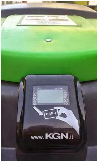
L'accesso alle Strutture Seminterrate (SSI) per il conferimento dei rifiuti avviene tramite il sistema di identificazione RF-Id dell'utente con “chiave elettronica” (tipo a card, portachiavi o simili) a transponder, che attiva l'elettro-serratura per l'apertura del coperchio secondario (piccolo) per il conferimento dei rifiuti ;
