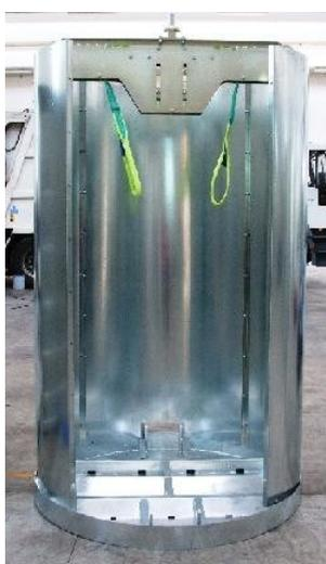
Il contenitore interno è in acciaio zincato a caldo per offrire un alto livello di sicurezza passiva e una bassa attaccabilità dagli agenti chimici e dal calore (pareti ignifughe). È dotato di un sistema di aggancio semi-automatico, che consente il sollevamento verticale, l’apertura e il riposizionamento senza interventi manuali da parte degli operatori, con caratteristiche e prestazioni uniche sul mercato.
